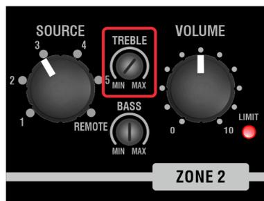
Pour la ZONE 2 connectée au sous-marin, baissez complètement TREBLE au minimum pour activer le mode LOW PASS FILTER.
