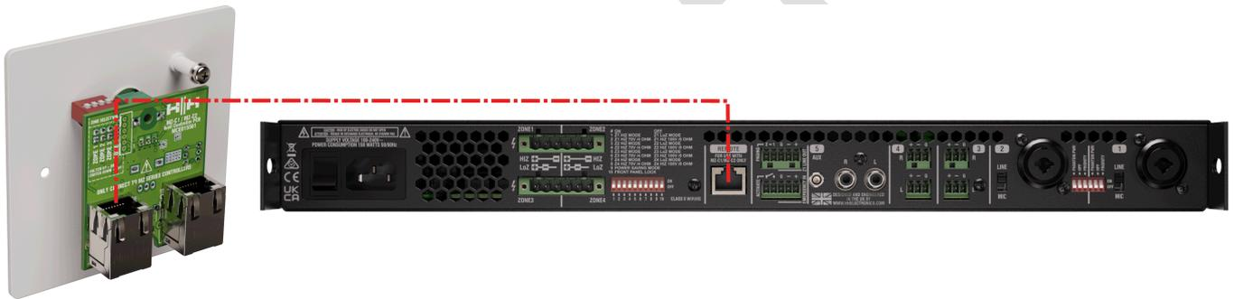
Si se requieren varios controladores de pared, deben conectarse en cadena de uno a otro. Hágalo conectando la **SALIDA** del controlador anterior a la **ENTRADA** del siguiente a través de un RJ45.
