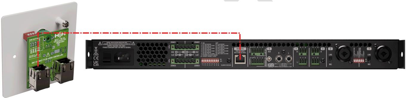
Si plusieurs contrôleurs muraux sont nécessaires, ils doivent être connectés en guirlande de l'un à l'autre. Pour ce faire, connectez la **sortie** du contrôleur précédent à l'**entrée** du suivant via un RJ45.
