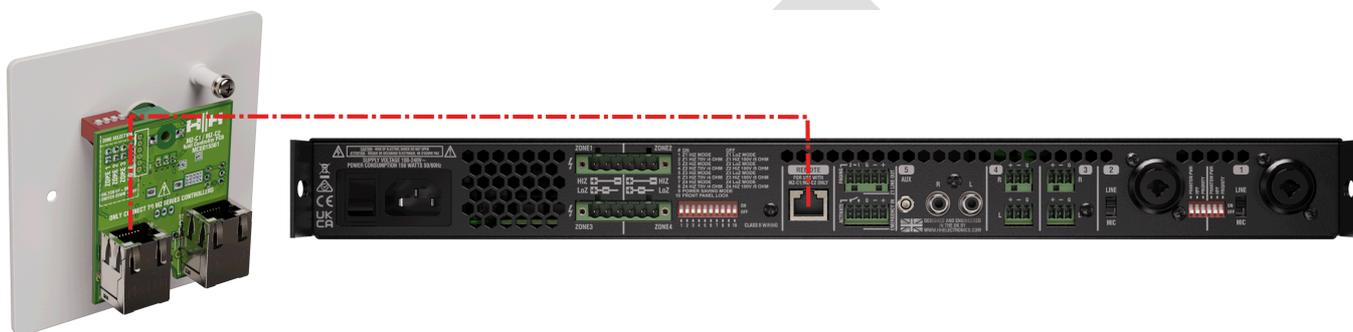
Se sono necessari più controller a parete, devono essere collegati a margherita da uno all'altro. A tale scopo, collegare l' **OUT** del controller precedente all'**IN** del successivo tramite un RJ45.
