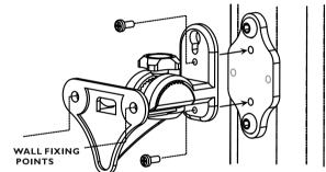
如图所示,将壁式支架安装到垫片上,并附带 M3螺钉。
