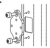
用5mm六角扳手拆下两个固定螺丝。再用相同的螺丝安装垫片(垫片包含在安装套件中)
