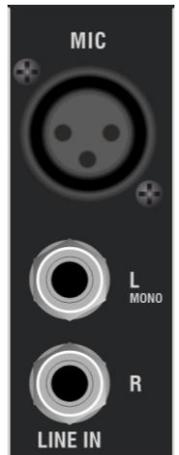
**HINWEIS: Verwenden Sie die MIC- und LINE-Eingangsbuchsen nicht auf einem einzigen Kanal. Dies gilt sowohl für Mono- als auch für Stereokanäle.**
