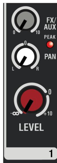
**REMARQUE : lorsque vous n'utilisez pas de canal, il est recommandé de maintenir le contrôle de niveau sur  $-\infty$  pour réduire le bruit au minimum.**
