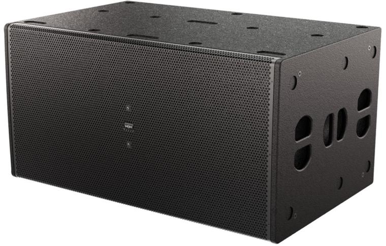
TNA-2800S 无源低音炮搭载两个 HH 设计的 18 英寸低频低音单元，配备 4 英寸音圈，最大声压级可达 138 dB 峰值，频率响应低至 32Hz。经过声学优化的箱体采用 18 毫米胶合板制成，并配有丰富的内部支撑。集成式吊挂硬件使 TNA-2800S 成为俱乐部、现场音乐表演场所和教堂等需要高输出低音增强的场所的理想解决方案。随附的重型脚轮方便运输，使 TNA-2800S 非常适合巡演。
