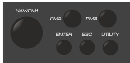
Le HH SP26 est équipé de 3 encodeurs relatifs, NAV/PM1, PM2 et PM3. Ces encodeurs vous permettent de naviguer dans l'interface utilisateur et de modifier les sections du processeur. L'encodeur rotatif NAV/PM1 est utilisé pour naviguer dans les menus et les sous-menus. Les encodeurs PM2 et PM3 permettent l'édition des paramètres sélectionnés.
