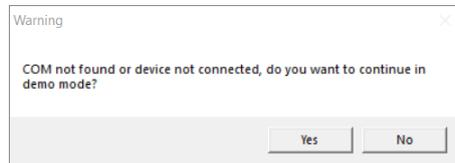
Le mode démo permet un fonctionnement complet sans avoir à connecter le matériel afin que les paramètres puissent être modifiés à l'avance.
