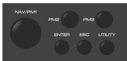
O HH SP26 está equipado com 3 Encoders Relativos, NAV/PM1, PM2 e PM3. Esses codificadores permitem que você navegue na interface do usuário e edite seções do processador. O codificador rotativo NAV/PM1 é usado para navegar pelos menus e submenus. Os encoders PM2 e PM3 permitem a edição dos parâmetros selecionados.
